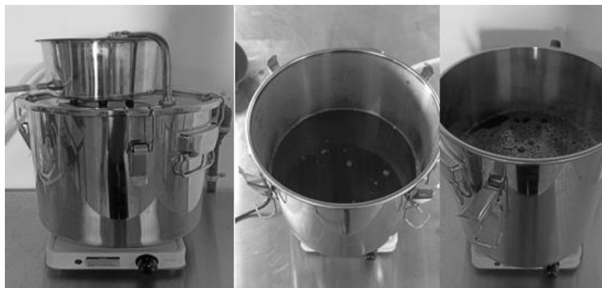
Figura 7. Destilación del bagazo preparado.
