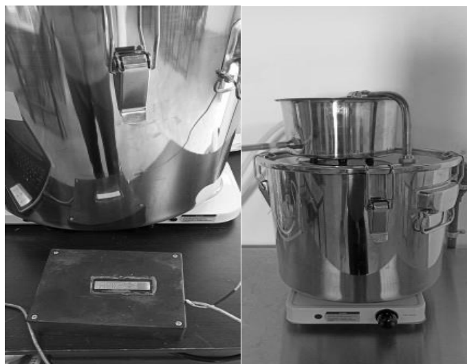
Figura 12. Destilador con monitoreo electrónico y parrilla con control ON/OFF
