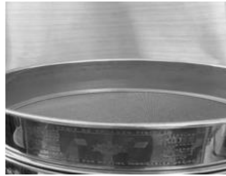
a) b) Figura 3. a) Equipo de Tamizado. b) Malla de tamizado No. 40
