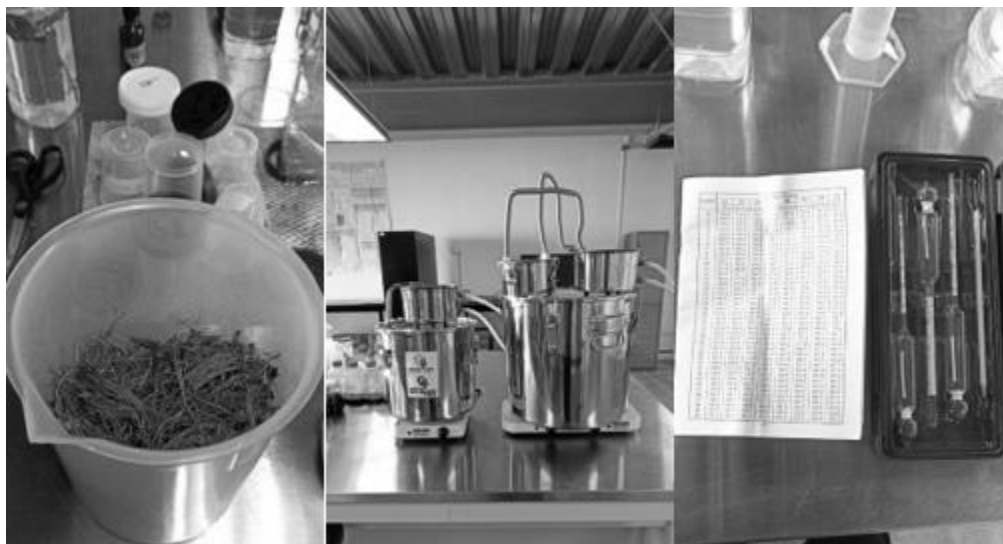
Figura 13. Bagazo, Destiladores y Densímetro de Alcohol
