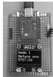
Figura 8. Nodo padre con ESP32-S2 mini
